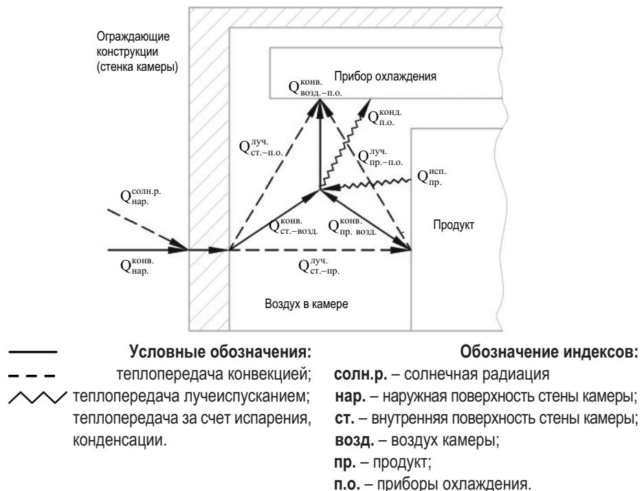
Рис. 1. Схема теплопритоков в камеру хранения через ограждающие конструкции
